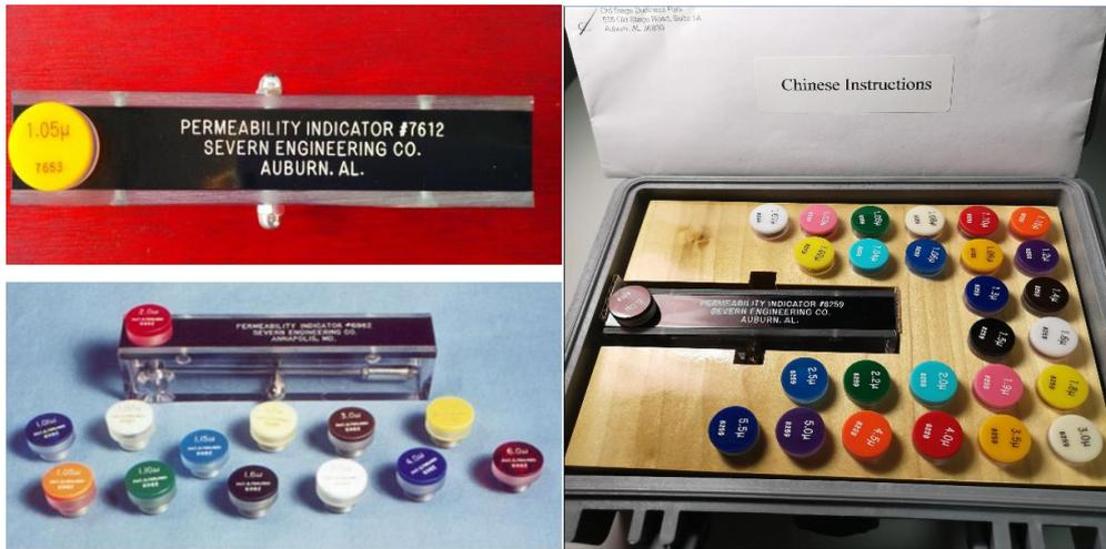
指示器重 85 克，长 127 毫米，使其适合手持操作，所有金属部件均镀亮镍，指示器和它的插入物都装在一个漂亮的木盒子里；该指示器符合 SE-ENG-96001 标准，可以替换早期 MIL-I-17214B 军标，指示器的操作基于永久条形磁铁与已知标准样品和未知材料的相互吸引，在使用中，将插入件拧入壳体顶部，然后通过依据于插入物的指定磁导率的力将磁体吸引到插入物上，然后使其从壳体底部的开口突出的磁铁端部与被测材料接触，指示器在垂直于接触表面的方向上移开，如果被测材料的磁导率高于插入件的磁导率，则当指示器移开时，磁体将首先与插入件断开接触，另一方面，如果被测材料的磁导率低于插入物的磁导率，则当指示器移开时，磁体将首先与材料断开接触；因此，通过互换插入物，可以判断归类被测材料磁导率，每套指示器含有 27 个不同标准值的插入试块，具体如下：
